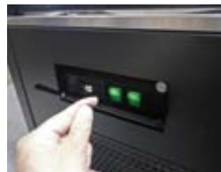
**Steuerung sowie Geräte Ein-/Ausschalter und Beleuchtung sind hinter magnetisch angebrachter Klappe leicht zugänglich und dennoch gut geschützt**
